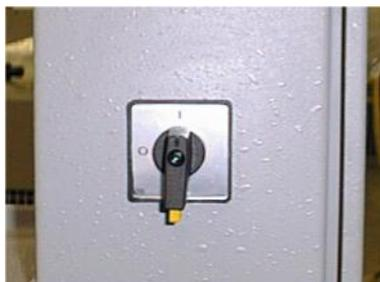
1) Включите главный выключатель ленточнопильного станка. Главный выключатель расположен на одной из сторон распределительного щита.
