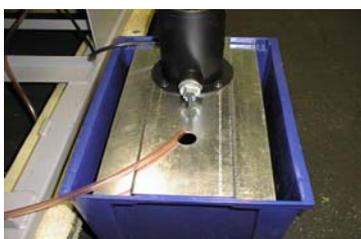
**2) Отсоедините патрубки, ведущие от бака к насосу. Отвинтите 4 винта на фланце насоса и снимите насос с держателя.**
