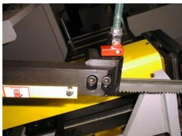
1) Отсоедините шланг СОЖ, снимите защитный кожух, пыльное полотно и блок с твердосплавными направляющими.
