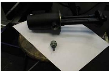
**6) Подсоедините четыре клеммы кабеля в прежнем порядке. Установите назад крышку клеммной коробки, не забыв про резиновое уплотнение. Подсоедините трубку подачи СОЖ к патрубку насоса. Установите насос в держатель и прикрутите его винтами. Верните бак на прежнее место.**
