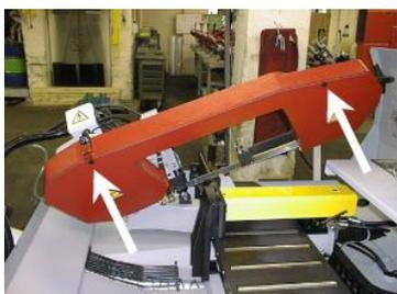
3) Снимите заднюю защитную крышку пильной рамы.
