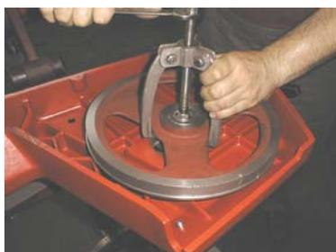
4) Наденьте съемник с тремя опорами и снимите шкив.
