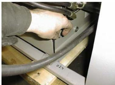
Демонтируйте винты крепления гидравлического бака.
