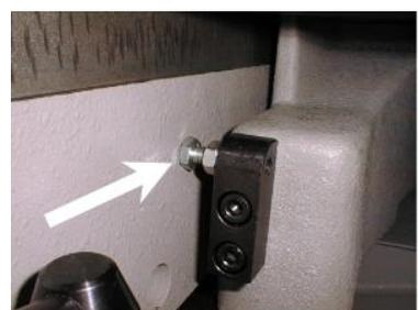
2) Ослабьте гайку и винт, в том случае если углы не правильно установлены. Установите требуемый угол.
