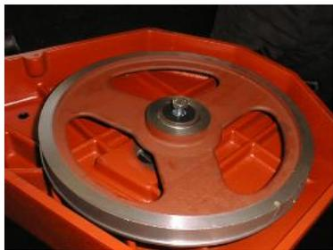
2) Отвинтите винт и снимите шайбу.
