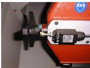
Это устройство контролирует натяжение ленты и немедленно останавливает машину, если та разрывается.
