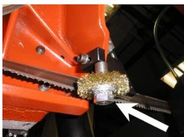
1) Открутите гайку на щетке, замените изношенную щетку на новую, закрутите гайку.
