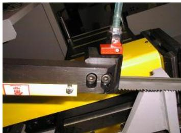
1) Отсоединить шланги СОЖ, защитный кожух, пыльное полотно и блоки твердосплавных направляющих.
