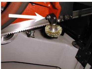
5) Установите щетку пильного полотна в рабочее положение.
