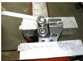
2) Закрепить блок в тисках, и демонтировать оба винта крепления роликовых направляющих.
