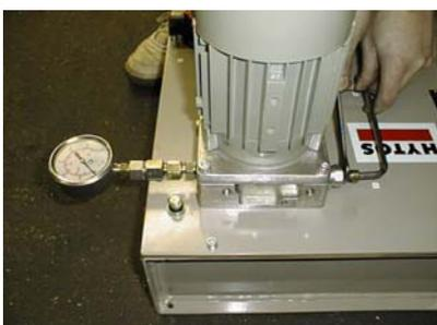
Ослабьте гайку регулировочного винта.
