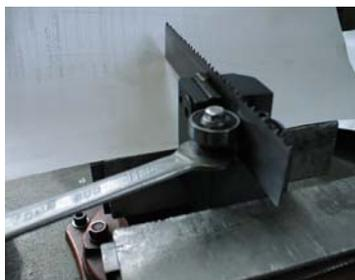
5) Вставьте отрезок пыльного полотна в блок (приблизительно 15 - 20 см).
