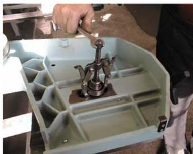
5) Если подшипник из шкива не снялся, то снимать подшипник рекомендуется съемником с двумя опорами. Если подшипник износился, то замените его на новый.
