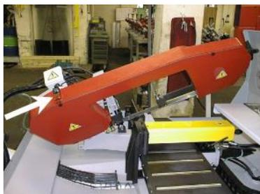
Если крышка поднята во время работы, то срабатывает датчик и пила останавливается. В режиме установки пилу запустить невозможно.
