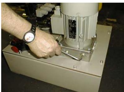
Выкрутите винт на блоке насоса.
