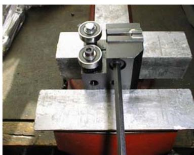
2) Зажмите блок в тисках. Вывинтите винты твердосплавных направляющих.
