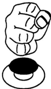
Кнопка "ПОЛНАЯ ОСТАНОВКА" используется для аварийного выключения станка в случае неисправности либо опасности для здоровья
