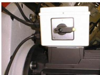
Выберите скорость реза заготовки пильным полотном. Скорость устанавливается по очереди с помощью переключателя.
