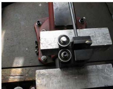
3) Выкрутите регулировочный винт с внутренней стороны блока.
