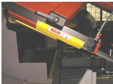
1) Ослабьте зажимной рычаг направляющей так, чтобы левый край блока с твёрдосплавными направляющими был ближе к заготовке.
