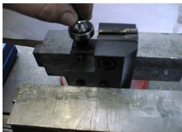
4) Надеть новые ролики на винты и установить в блок.
