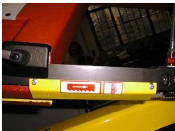
2) Снимите желтый защитный кожух. Кожух закреплен винтом.
