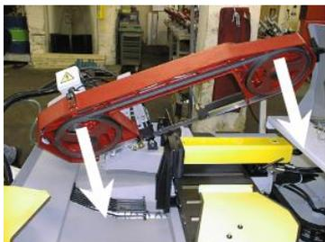
5) Ослабьте натяжное устройство. Снимите пильное полотно со шкивов.
