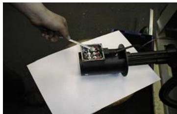
**5) Снимите крышку клеммной коробки нового насоса. Ослабьте втулку, пропустите через неё кабель в клеммную коробку и затяните его.**
