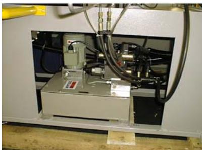
Выньте гидравлический бак из ленточнопильного станка.
