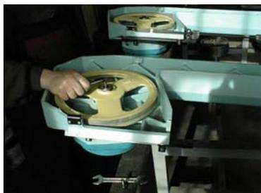
2) Отвинтите винт крепления шкива и удалите шайбу..
