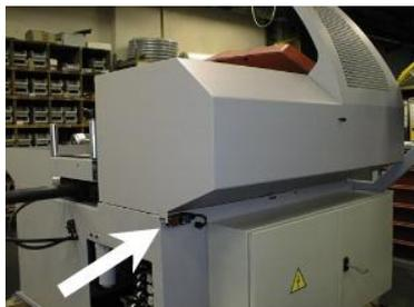
Это защитное устройство позволяет обслуживающему персоналу входить в зону действия подающего устройства во время работы и предохраняет от получения повреждений.
