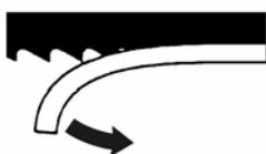
Удаляйте защитную полосу только после того, как вы установили и закрепили полотно пилы.
