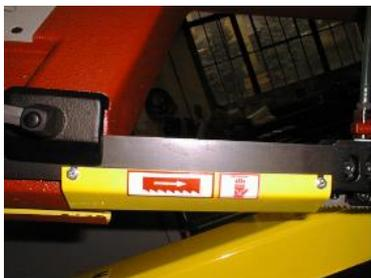
7) Установите желтый защитный кожух пильного полотна.
