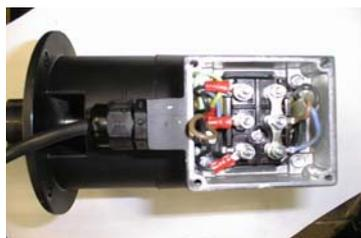
**3) Снимите крышку клеммной коробки насоса. Отсоедините четыре клеммы кабеля.**
